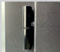
Fiches laquées Ø13x60 réglables à vis invisibles et bagues Téflon anti-usure sans rupture de joint
