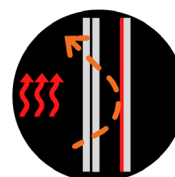
-Isolation thermique- Double vitrage One à couche thermique renforcée Ug=1.0
