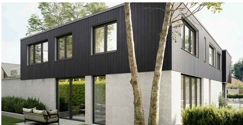
Double vitrage 4fe/20/4 avec gaz Argon à bords chauds WarmEdge (Ug=1.1w)
