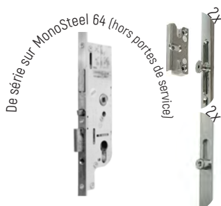
Serrure automatique Fercomatic (SA) 5 points dont 2 avec rouleaux champignons et gâches anti-écartement
